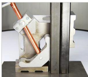
▶ gefräste Seiten zum Aufrechtstellen der Metallwinkelspanner
