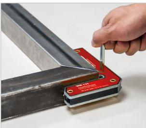
Sechskantloch zum Ablösen des Magnetwinkels.
