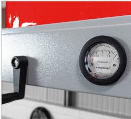
Filterüberwachung über Manometer
