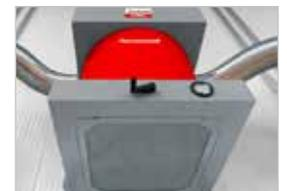
Integrierte Hebevorrichtung für den Filterwechsel
