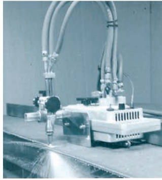
ProFIT für automatische Geradeschnitte durch Winkelprofilführung
