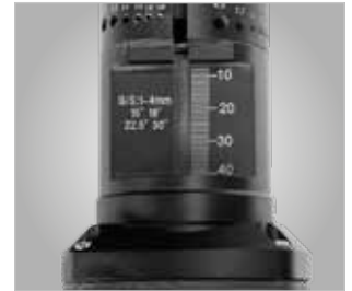
Schleif- und Ablängmöglichkeiten für verschiedene Elektrodendurchmesser
