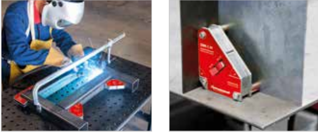
zum Halten von metallischen Werkstücken im 45° oder 90°-Winkel
