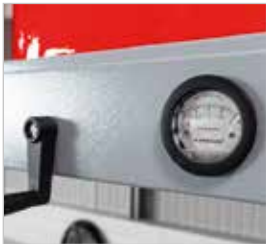
Filterüberwachung über Manometer
