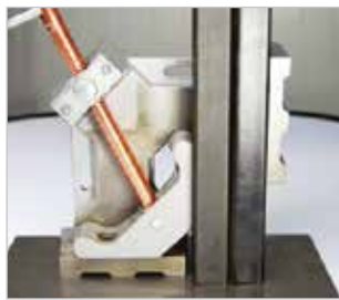
▶ gefräste Seiten zum Aufrechtstellen der Metallwinkelspanner
