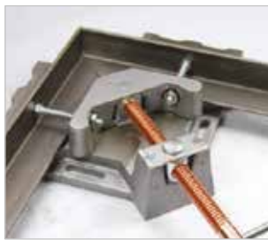
▶ mit Vorrichtung zur besseren Klemmung von Profilen
