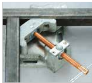
▶ Fixierung von T-Verbindungen durch offene Bauweise möglich
