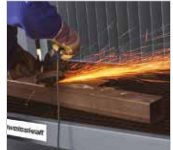
Hoher Schleifstauberfassungsgrad aufgrund der Rückwanderfassung
