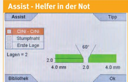
► Neue und nur bei REHM Geräten verfügbare Möglichkeit ein WIG-Schweißgerät einzustellen. Die Einstellung erfolgt über die Auswahl von Grundwerkstoff, Nahtform und Materialstärke.
