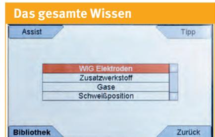
► Selbst bei der Auswahl von Gasen, Elektroden oder Zusatzwerkstoffen unterstützt der TIGER® den Anwender. Welcher Zusatzwerkstoff darf verwendet werden? Der TIGER® hat die Antwort.
