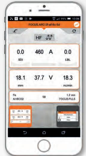
Die SIRIUS-App führt Sie bei der Auswahl der eigenständigen Optimierung Ihrer Schweißtechnologie, Easy Connect verbindet Sie problemlos mit SIRIUS und damit dem Schweißgerät.
