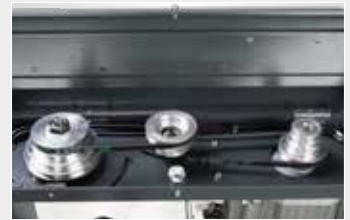
Abb. Riemenantrieb DQ 22. Bei DQ 14/18 zwei Riemenscheiben
