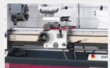
ABDECKUNG › Leit und Zugspindeabdeckung aus Edelstahl
