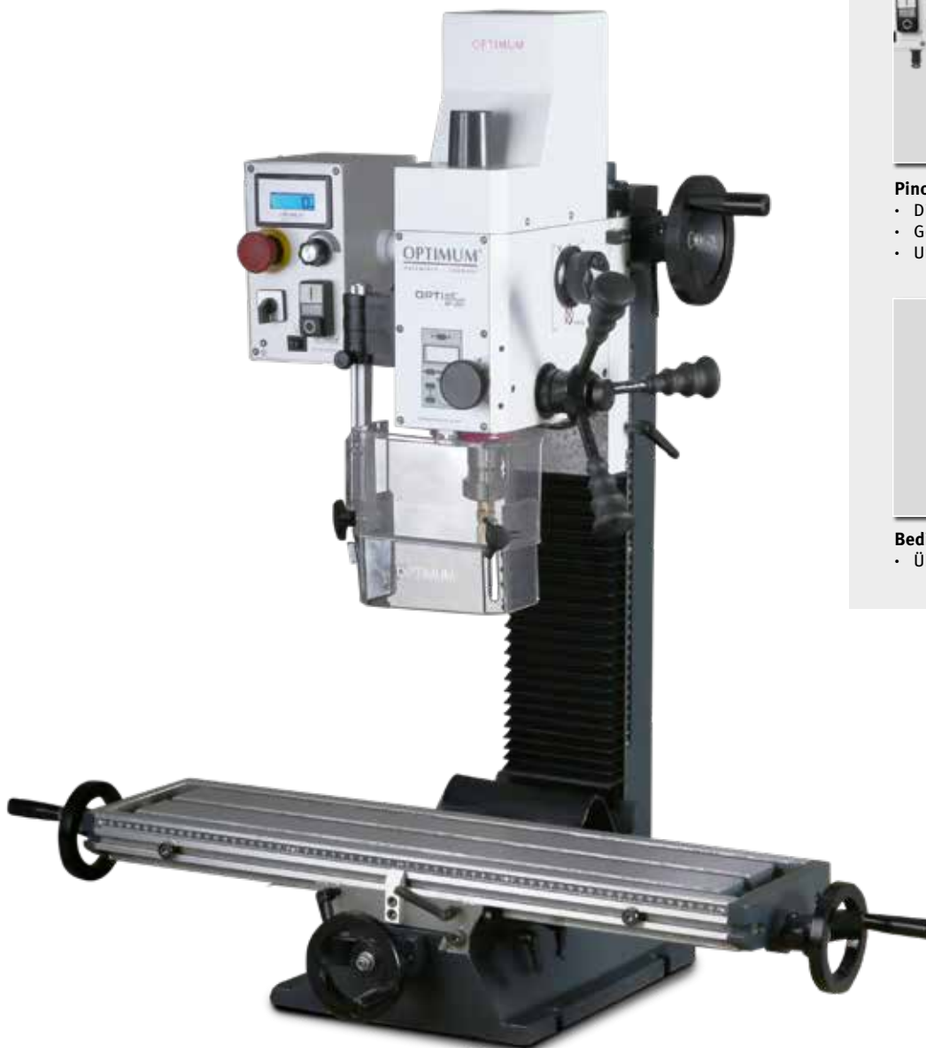
Abb.: OPTImill BF 20Vario mit optionalem Zubehör
