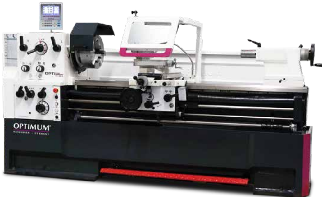
Abb.: TH 5615D mit optionalem Drehfutter
