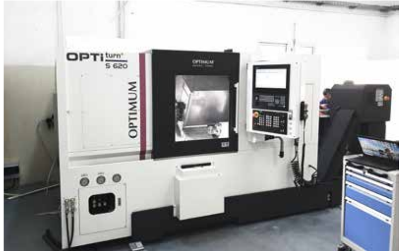
OPTIMUM PREMIUM CNC-Schrägbett-Drehmaschine S 620 mit Gegenspindel
