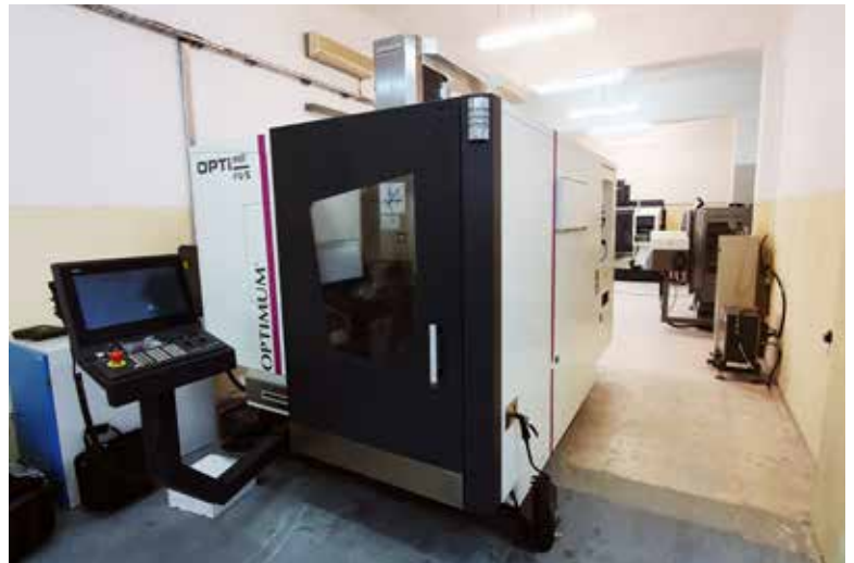
OPTIMUM PREMIUM CNC-Schrägbett-Drehmaschine S 620 mit Gegenspindel
