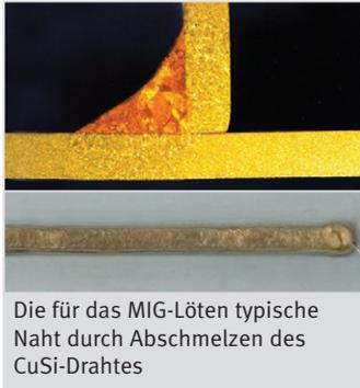
Die für das MIG-Löten typische Naht durch Abschmelzen des CuSi-Drahtes
