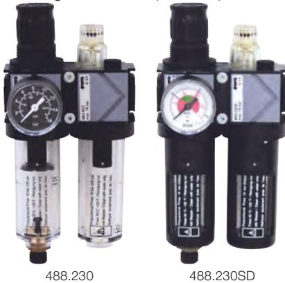
**Standardausführung: Regelbereich (p<sub>2</sub>) 0,5–10 bar, Kunststoffbehälter mit Handablassventil, mit Manometer, Filterporenweite 40 µm, Blockmontage mit Kompaktverbindungs-Set mit integriertem T-Halter zur Wandbefestigung**
