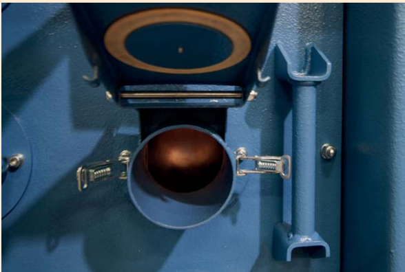
Frontanschlüsse für bis zu 6 Schläuche
